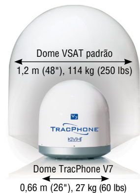
O KVH TracPhone V7 tem um volume 85% menor que as antenas VSAT tradicionais, tornando a instalação significativamente mais fácil e barata.
